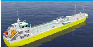
Ombygging av frakteskip til hybrid LNG-bunkringsfartøy (Øytank Bunkerservice/EGN)
