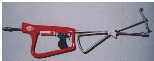
Figur 25: Skjærslokken er en integrert Hydroabrasiv skjæreenhet som etter å ha skåret hull i veggen tilfører vanntåke inne i bygningen.
