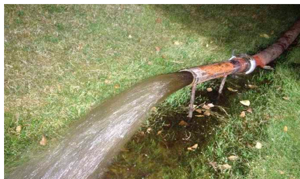
Figur 11: Fullskala tappeprøver fører vanligvis til spyleeffekt i ledningsnettet og forringet vannkvalitet.
