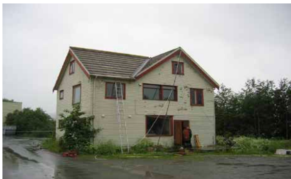
Figur 38: Hus på Melhus som ble brukt som øvelsesobjekt for brannvesenet. Det hvite røret som er ført opp til mønet er et vanlig vannrør. Dette ble koplet til brannbilens pumpe-uttak og førte en meget begrenset vannmengde inn på loftet etter at brann var påtent i første og andre etasje.
