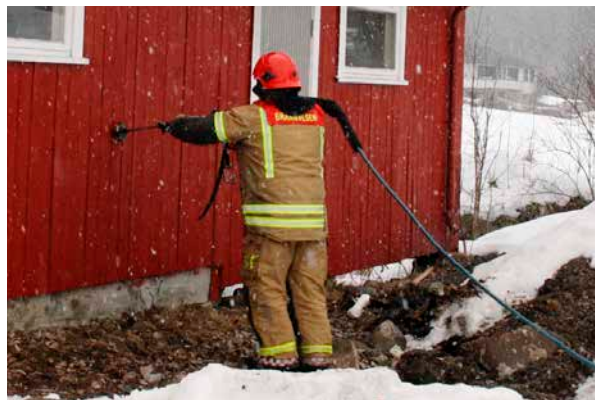
Figur 26: Bruk av skjærslokker. Man kan stå utenfor bygningen og slokke brann på innsiden uten å tilføre brannen luft.
