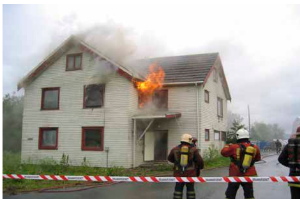
Figur 29: Test av vanntåke som overtenningsbeskyttelse på loft, utført av SP Fire Research (Vedlegg C). Loftet ble beskyttet med totalt 8 l/min (0,13 l/s) og hindret spredning av brann fra 2. etasje.
